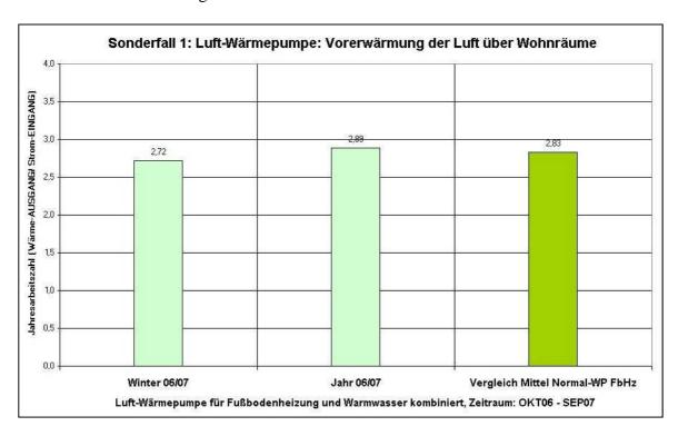
Die linke Säule stellt die Arbeitszahl in der Heizperiode dar und die mittlere den ganzjährigen Wert. Der Vergleich mit dem Mittel von sieben Normal-Wärmepumpen (rechts) zeigt, dass sich in beiden Fällen praktisch kein Vorteil ergibt. Offensichtlich handelt es sich hier um eine Überlüftung mit einem Wärmekurzschluss. Eine zusätzliche Wärmerückgewinnung aus der Abluft der Wohnräume (4- statt 2-Rohr-Anschluss) wäre in diesem Fall günstiger gewesen.
