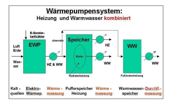
Nebenbei: Während vor und hinter dem Heizungspufferspeicher die Wärmemenge (kWh = Kilowattstunde) direkt gemessen wird, erfolgt die Ermittlung der Warmwasser-Wärmemenge über die Messung des Durchflusses (m³ = Kubikmeter) und der Multiplikation mit einem Faktor, so wie das bei der Abrechnung mit Mietern üblich ist.
