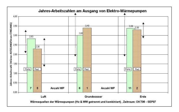
Die beiden linken Säulen stellen die gemittelten Arbeitszahlen der **Luft**-Wärmepumpen dar, gemessen direkt an deren Ausgängen, und zwar für Fußbodenheizungen (grüne Säule: Mittel JAZ = 2,83) und Radiatorheizungen (gerastert: Mittel JAZ = 2,30). Die Zahlen am Fuß der graphischen Darstellung informieren über die Anzahl der gemittelten Wärmepumpen und die senkrechten Pfeile an den Säulen über die Variation der Einzelwerte (durchgezogen: Hauptfeld, gestrichelt: Extreme).
