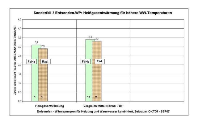
Die Jahresarbeitszahlen bewegen sich um JAZ = 3 und liegen damit um etwa 0.3-0.4 - Arbeitszahlpunkte unter dem Mittel vergleichbarer Normal - Erdsonden-Wärmepumpen (Säulen in der Mitte der gpaphischen Darstellung). Ein Vorteil der Heißgasentwärmung für die Warmwasserbereitung bis  $65^{\circ}$ C ist nicht erkennbar.
